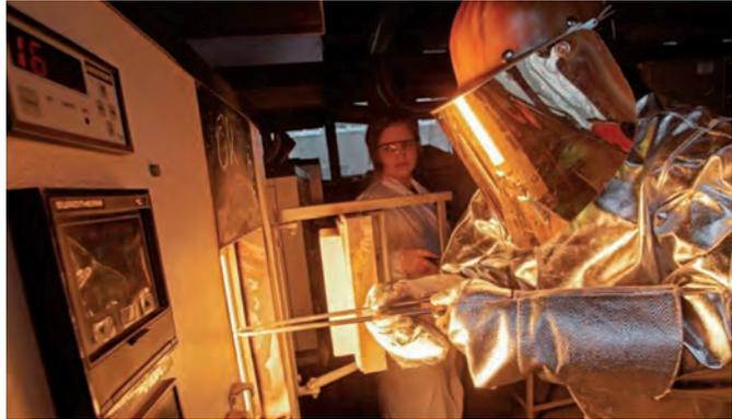
Keramische Feuerfestwerkstoffe haben einen hohen Schmelz- bzw. Erweichungspunkt, hohe Temperaturwechselbeständigkeit und gute chemische Beständigkeit. Je nach Anwendungs- und Einsatzzweck halten feuerfeste Erzeugnisse Temperaturen bis zu 2.500 °C stand. (Foto: TU Bergakademie Freiberg/SFB 920)
