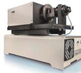
RUMUL ist Ihr spezialisierter Partner für präzise, energiesparende Ermüdungsprüfung im HCF- und VHCF-Bereich sowie für Bruchmechanik. Die platzsparende RUMUL CRACKTRONIC für Torsions-, Biegewechsel-, Zug- oder Druckschwellbelastung ist auch an Lehranstalten sehr beliebt und erlaubt auf einfache Art anspruchsvollste Forschungsarbeiten durch zu führen.
